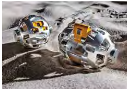
超小型の変形型月面ロボットLEV-2（JAXA/タカラトミー/ソニーグループ(株)/同志社大学）
